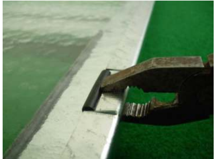
Pomocí kleští jemně přitlačíme příchytku (poz. 83-1)
