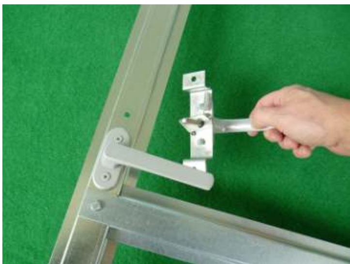
Montáž vnitřní části kliky
